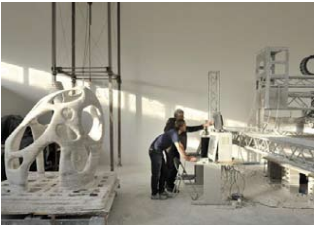
Figure 12. Réalisation de structures en ciment-résine selon le principe de l'impression 3D, Enrico Dini/D-Shape (source : www.iaac.net ).
