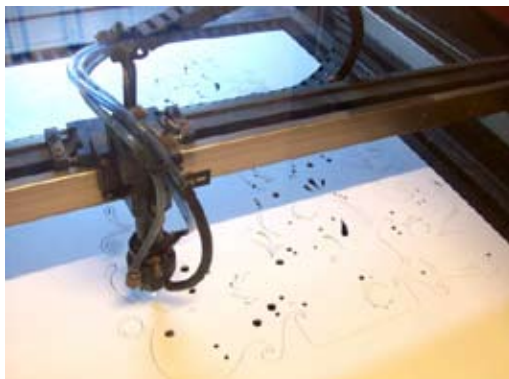
Figure 10. Machines à découpe numérique permettant la réalisation de formes complexes (source : www.designcenter.be ).
